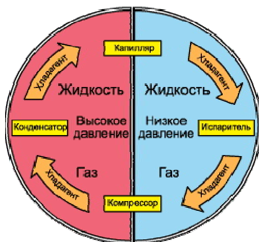
Рис. 1. Схема движения хладагента по контуру холодильного аппарата
