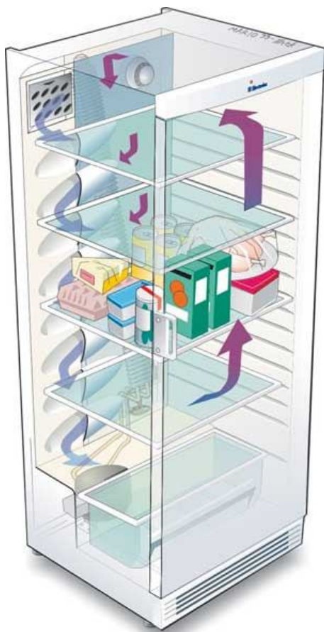
Рис. 16. Динамическая система охлаждения DME (Electrolux)
